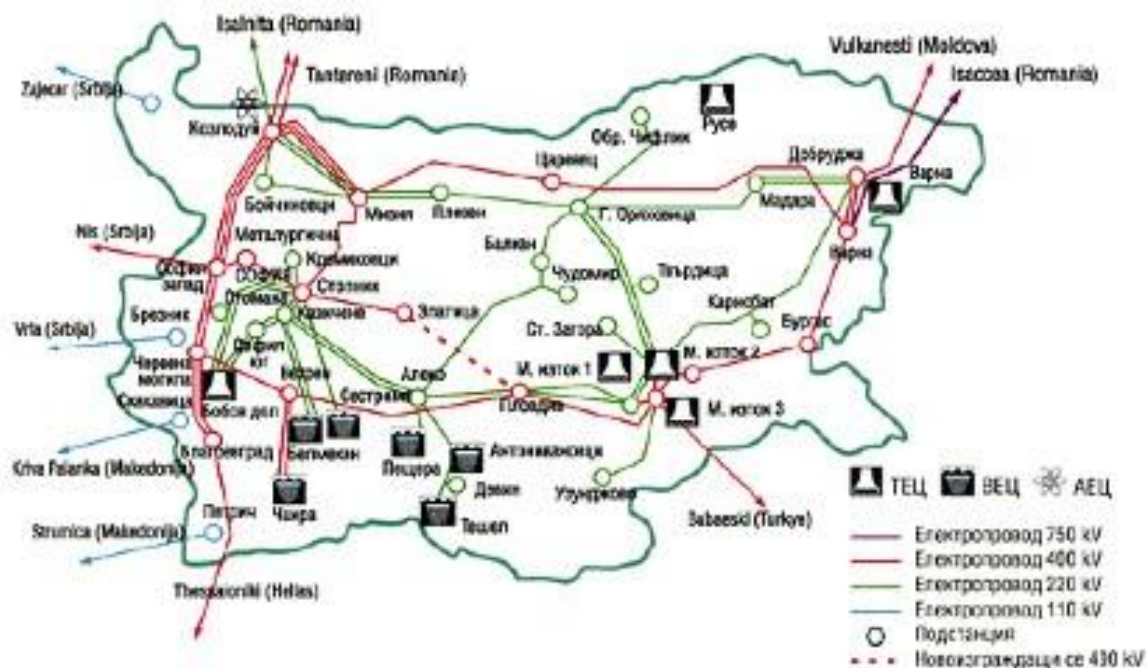
Figure 1. Réseau de transport bulgare. Source : NEK (ABS Energy Research, 2011). Le réseau de distribution électrique n'est pas affiché.
